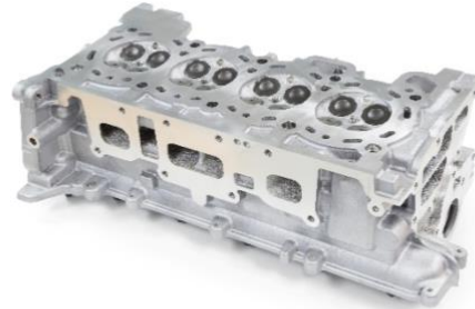
3D-Druck: Formen und Werkzeuge zur Herstellung komplexer Komponenten wie beispielsweise Motorteile aus Aluminiumguss
